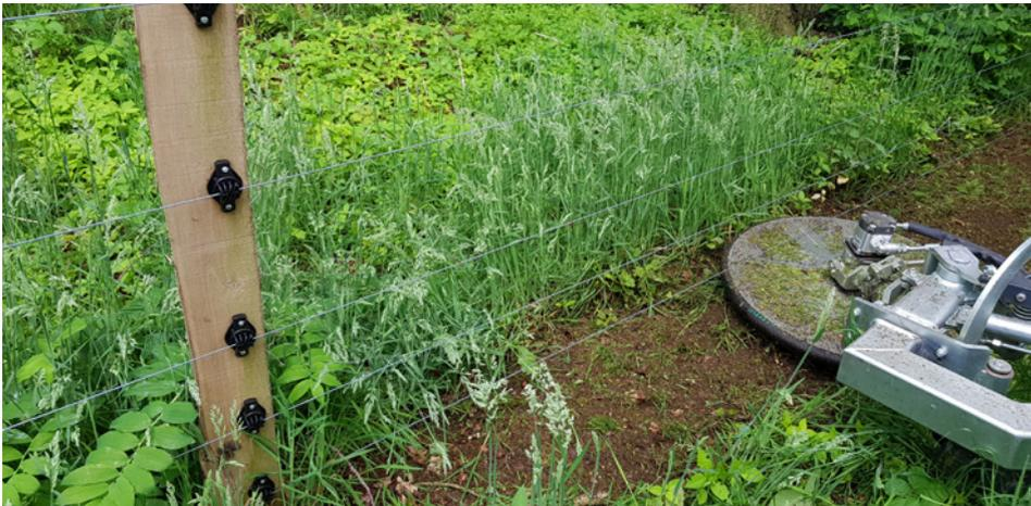
**Abb. 5:** Spezialanbaugeräte wie das Unterzaunmähwerk erleichtern die Arbeit beim Freimähen der untersten Zaunlitze. Foto: J. Cordes
