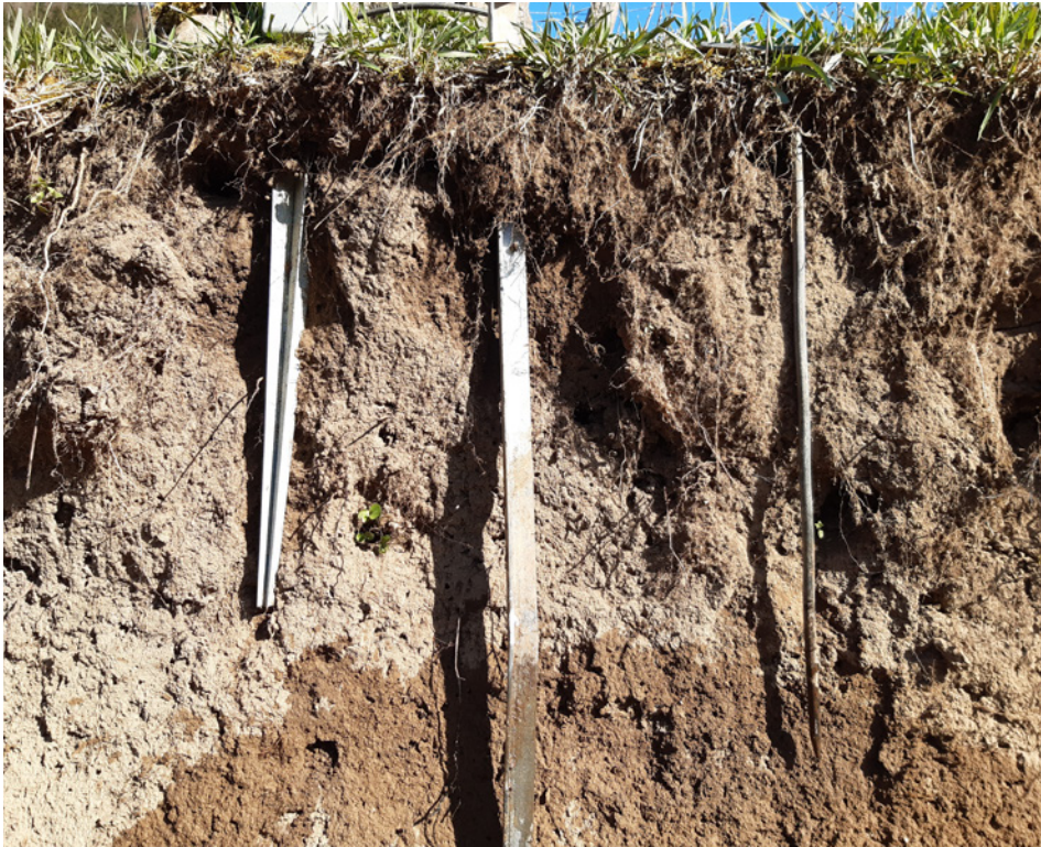
Abb. 4: Verschieden lange Erdungsstäbe bei simuliertem Grundwasserspiegel. Foto: F. Lamprecht
