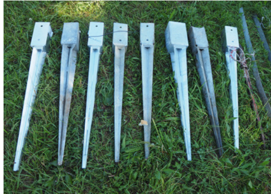
Abb. 9: Einschlagbodenhülsen eignen sich als Erdungsstab. Foto: DVL
