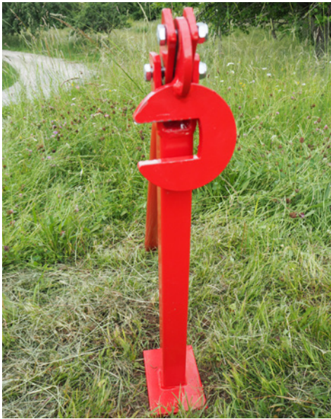
Abb. 10: Mit einem Pfostenheber lassen sich Erdungsstäbe leicht wieder herausziehen. Foto: DVL
