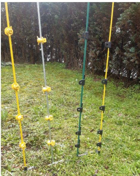
Abb. 15: Zaunpfosten mit verschiebbaren oder variabel einsetzbaren Isolatoren helfen bei der Anpassung an das Geländeprofil. Foto: F. Lamprecht
