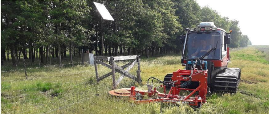
**Bild:** Zaunmäher zum Ausmähen der unteren Litze. Foto: R. Riesenbeck
