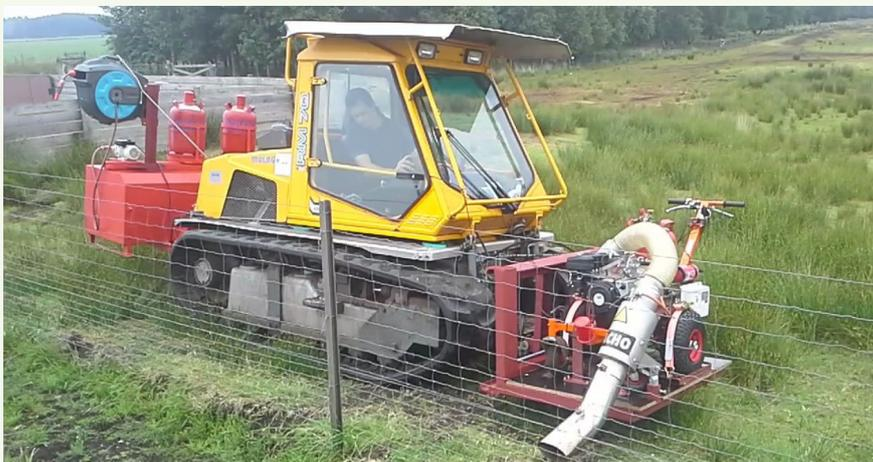
**Bild:** Heißluft-Unkrautvernichter. Foto: R. Riesenbeck
