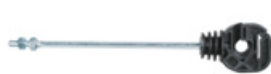
Abb. 8: Beispiel für Abstandsisolator. Sie halten den stromführenden Leiter zwischen 15 – 40 cm vom Zaun entfernt, hält entweder Nutztiere innen vom Hauptzaun weg oder den Wolf außen am Zaun (z.B. als Nachrüstung von Gatterwildzäunen).
