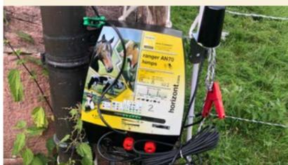
Netzgerät mit integrierter Zaunspannungsüberwachung
