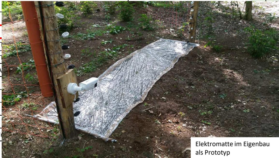
Elektromatte im Eigenbau als Prototyp
